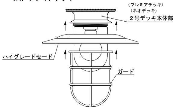
・ハイグレードセードを使用する2号・R2号・ネオ・Rネオ・プレミア・Rプレミアデッキは必ず器具を下向きに設置して使用ください。また、本体重量が重い為、天井の強度など落下のないことを確認の上、使用ください。
