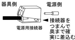
2 屋外設置の場合は接地用接続器に接地線を接続する。
