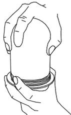
4 ランプを交換して逆手順で本体を持ってグローブとセードとガードを取り付ける。
