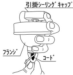
2 天井の配線器具に引掛シーリングキャップを取り付ける。
